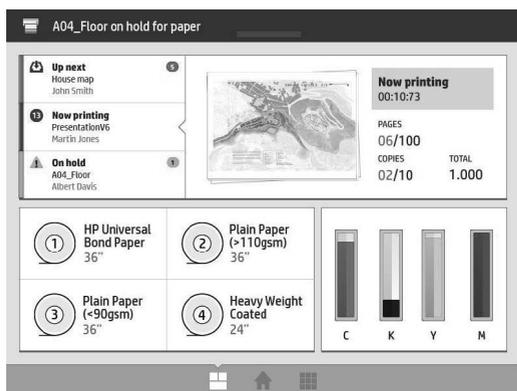
На передней панели большая центральная область отображает значки и графики. С левой и правой сторон в различное время могут отображаться до шести фиксированных значков. Обычно они не отображаются одновременно.
